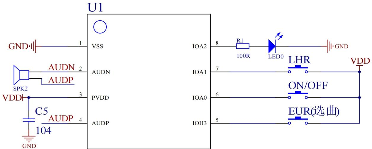
备注：电源两端务必加104P电容，距离VDD保持在10MM以内为佳。
