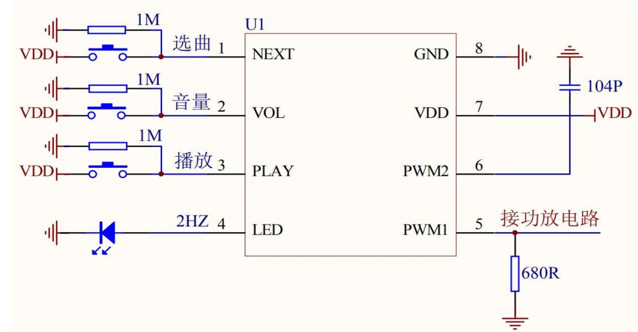
备注：电源两端务必加104P电容，距离VDD保持在10MM以内为佳
