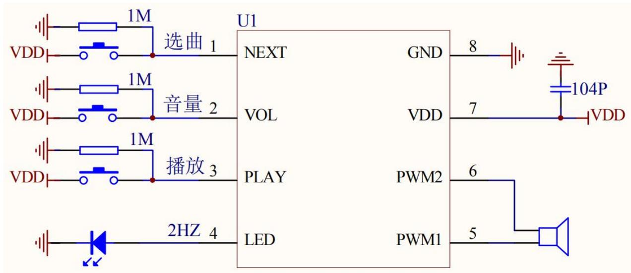
备注：电源两端务必加104P电容，距离VDD保持在10MM以内为佳
