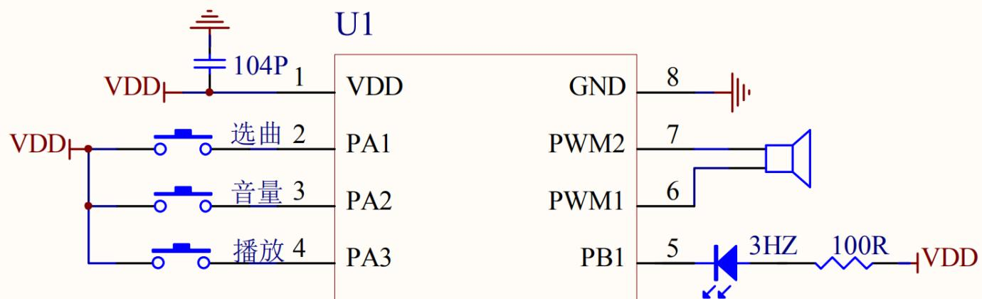
备注：电源两端务必加104P电容，距离VDD保持在10MM以内为佳。
